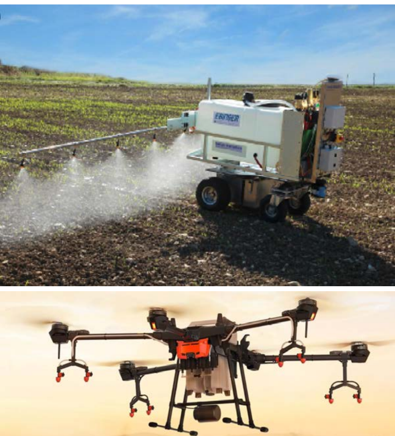
Figura 1 . Exemplo de um dos modelos autónomos terrestres e aéreo para a aplicação de produtos de proteção de plantas
