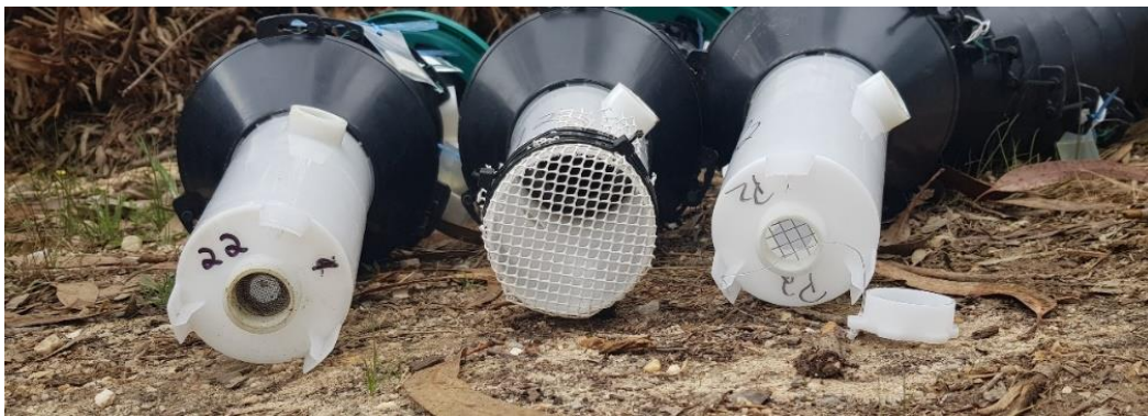
Figura 3 - Detalhe dos copos coletores das armadilhas multi-funil utilizadas no ensaio efetuado em 2021 nos concelhos de Seia e Soure. A primeira, copo comercializado, a segunda protótipo com o fundo substituído por uma rede plástica e a terceira, copo modificado pelo fabricante.
