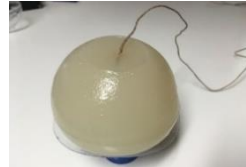
f) Simulador de fruto em agar com termopar colocado a uma profundidade de 7 cm
