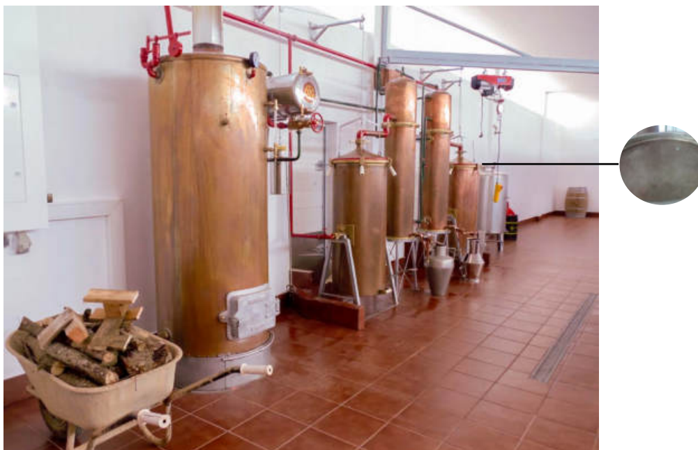
Figura 3. Sistema de alambique de colunas de arraste de vapor para destilação de aguardentes, com indicação do filtro no topo da coluna - Destilaria Luís Sequeira - Silves.
