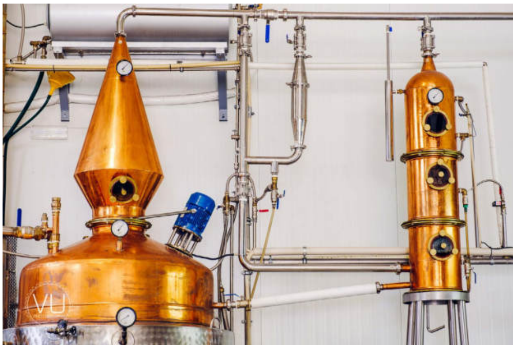
Figura 5. Sistema de alambique de colunas de arraste de vapor para destilação de aguardentes, com indicação do filtro no topo da coluna – Destilaria Luís Sequeira – Silves.
