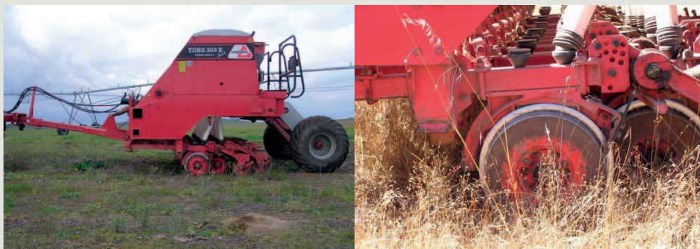
Figura 2 – Semeador de sementeira directa
