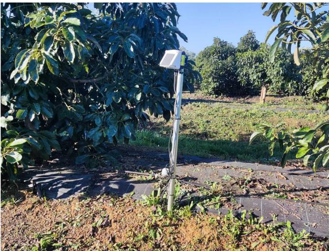
Sistema Hidrosoph para monitorização em tempo real da humidade do solo e da rega.
